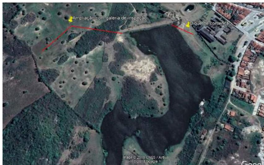
**Figura 4** – Readequação com inversão dos eixos da barragem
