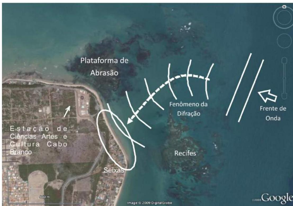
**Figura 01.** Fenômeno de difração de onda, ocasionado pela abertura dos recifes localizado em frente ao Seixas, deixando a Praia com uma configuração de arco e extensão aproximada de 900 metros.
