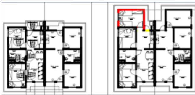
Figura 03: À esquerda, planta das casas térreas geminadas. À direita, planta das casas térreas geminadas com expansão em vermelho.
