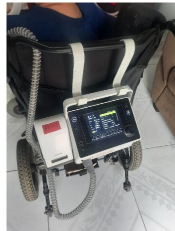
Imagem 2: Ventilador adaptado à cadeira
