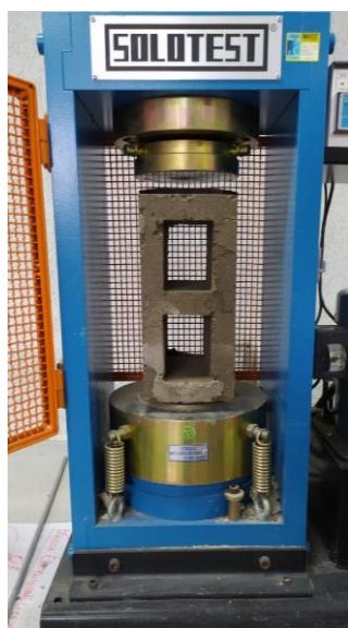
Figura 15- Ensaio de Rompimento com 0% de PE Figura 16- Ensaio de Rompimento
