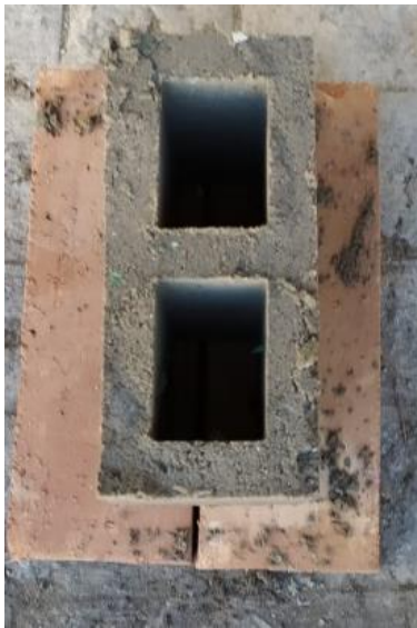
Figura 6- Bloco de Concreto com 0% de PET 2,5% de PET
