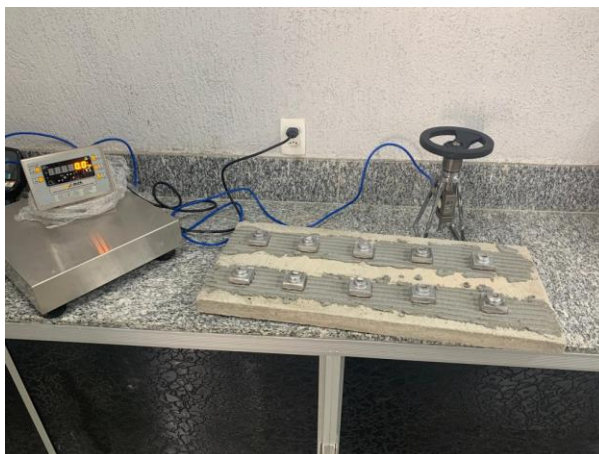
Figura 5 - Limpeza das placas cerâmicas e colagem das peças de alumínio.
