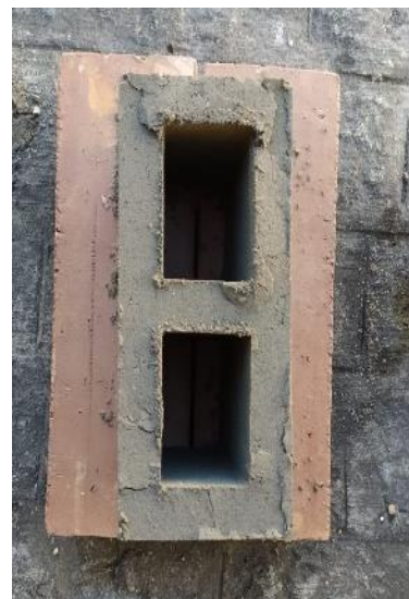
Figura 9- Bloco de Concreto com
