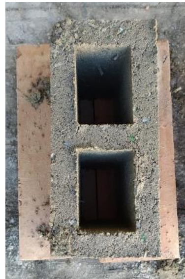
Figura 7- Bloco de Concreto com
