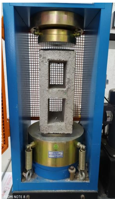
Figura 17- Ensaio de Rompimento com 5% de PET Figura 18- Ensaio de Rompimento com 7,5% de PET
