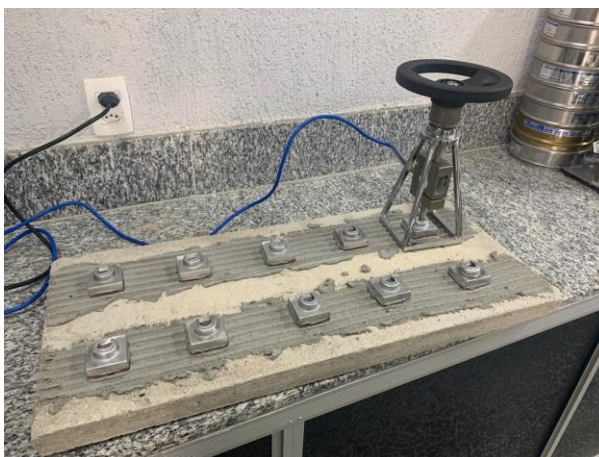
Figura 6 - Dinamômetro de tração acoplado na peça de alumínio.
