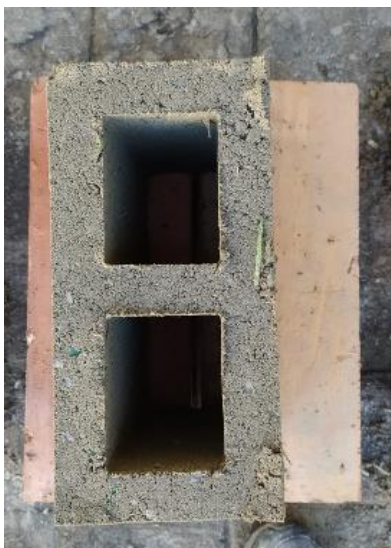
Figura 8- Bloco de Concreto com 5% de PET 7,5% de PET
