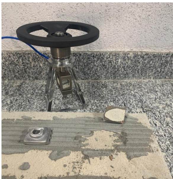
Figura 8 – Rompimento entre substrato e argamassa colante.
