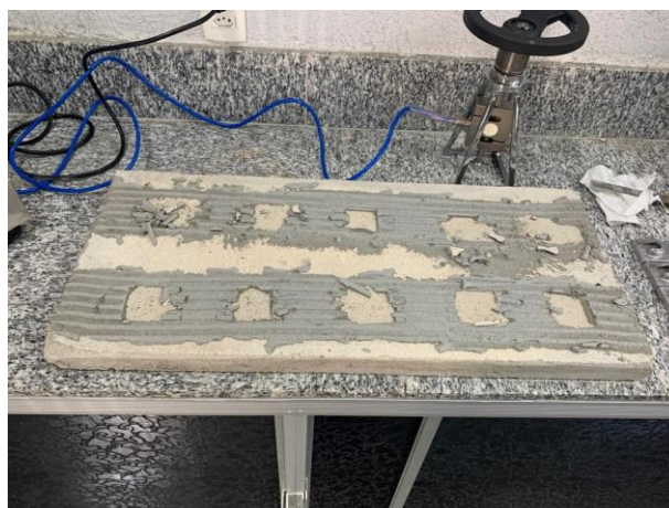
Figura 9 – Placa de concreto armado após todos os arrancamentos.
