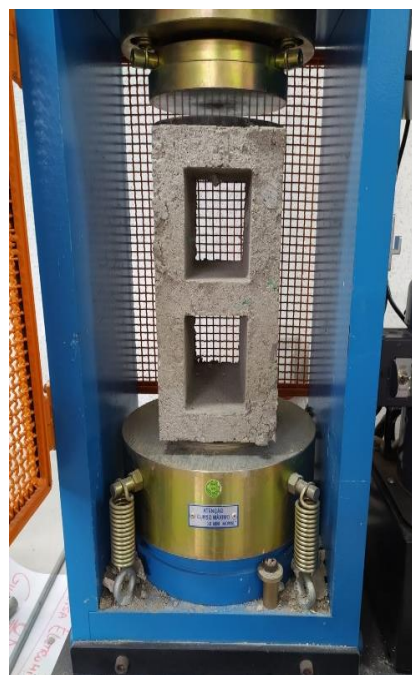
Figura 17- Ensaio de Rompimento com 5% de PET Figura 18- Ensaio de Rompimento com 7,5% de PET
